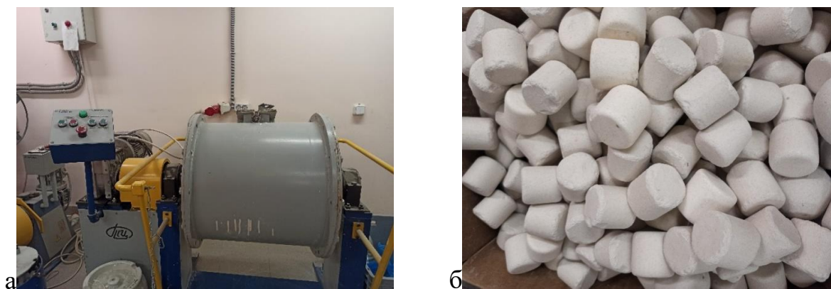
Рисунок 2.1 – Шаровая лабораторная мельница РМШ-200 (а); уралитовые мелющие тела (б)
