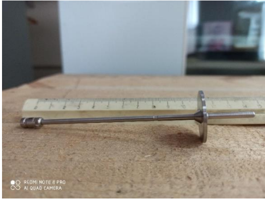
Рисунок 4.11 – Внешний вид применяемого дискообразного шпинделя R5 в качестве насадки для Ротационного вискозиметра Fungilab.
