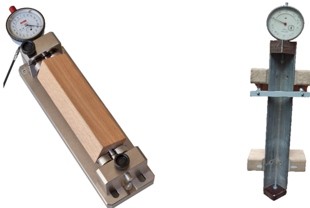
Рисунок 2.3 – Типовой прибор для определения линейной усадки со стрелочным индикатором
