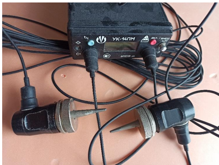
Рисунок 2.5 – Внешний вид Бетоноскопа УК-14ПМ
