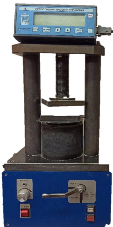
Рисунок 2.4 – Пресс гидравлический лабораторный ПГМ-100МГ4
