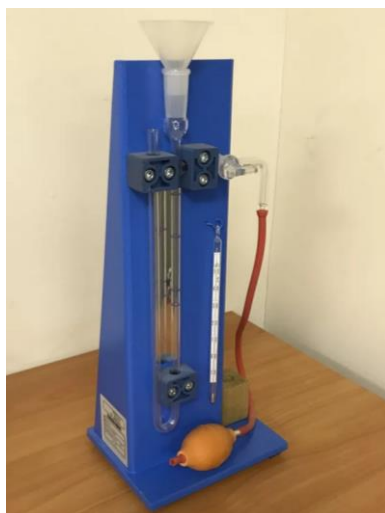
Рисунок 2.2 – Прибор Товарова для определения воздушной проницаемости слоя порошка
