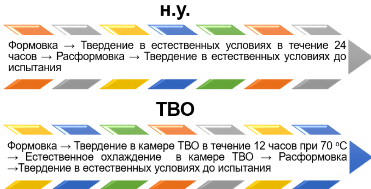
Рисунок 4.5 – Применяемые режимы консолидации для экспериментальных составов гипсосодержащих шлакощелочных вяжущих
