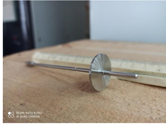
Рисунок 4.11 – Внешний вид применяемого дискообразного шпинделя R5 в качестве насадки для Ротационного вискозиметра Fungilab.
