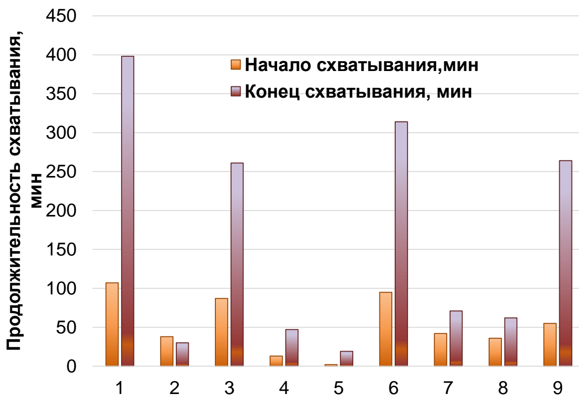
Рисунок 4.4 – Влияние компонентного состава щелочеактивированных вяжущих на их сроки схватывания
