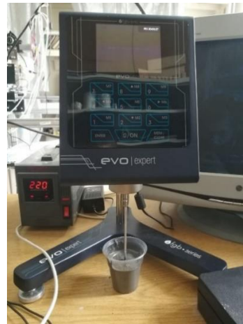
Рисунок 4.12 – Процесс съемки реологических параметров гипсосодержащей щелочеактивированной пасты с помощью ротационного вискозиметра Fungilab.
