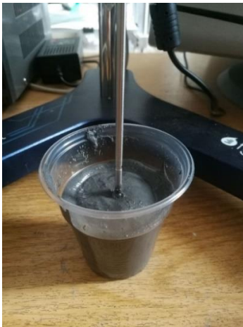
Рисунок 4.12 – Процесс съемки реологических параметров гипсосодержащей щелочеактивированной пасты с помощью ротационного вискозиметра Fungilab.
