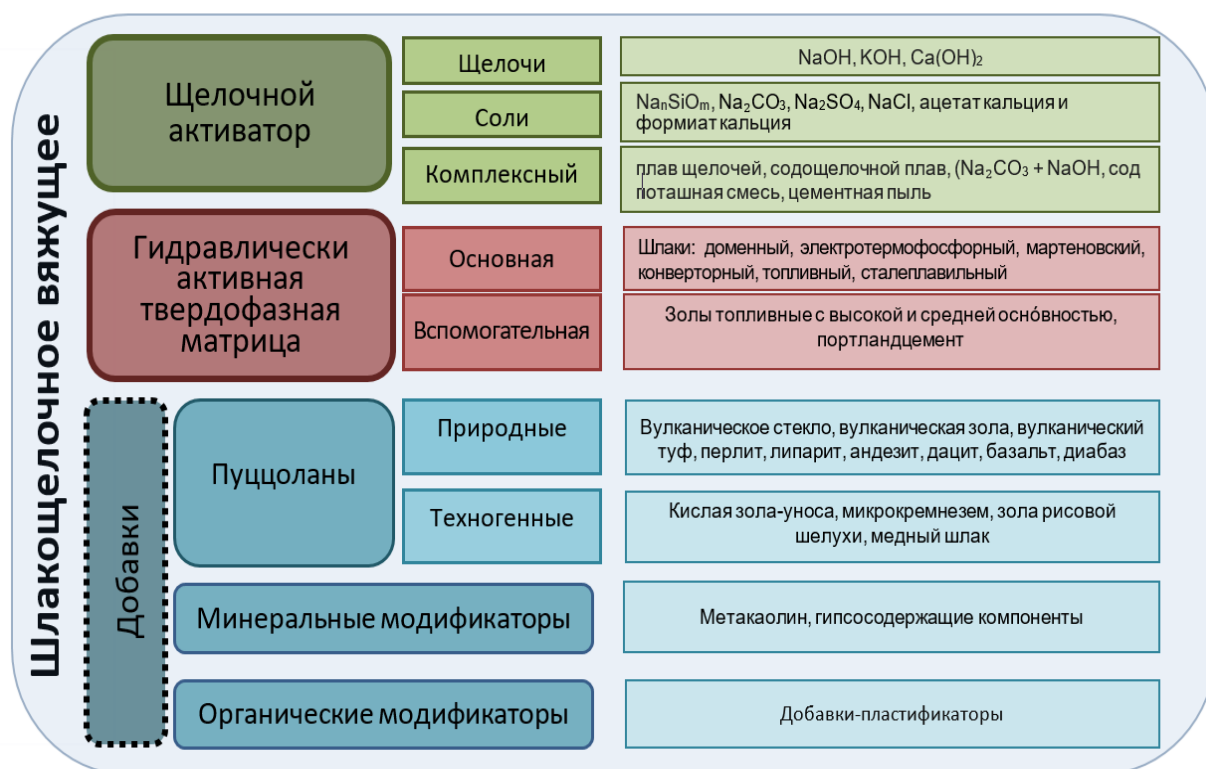
Рисунок 1.4 – Принципиальная схема компонентного состава шлакощелочных вяжущих
